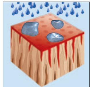
*Mit Kapillarblocker: Durch die spezielle Veredelung der PaX-Fenster mit Kapillarblockern wird das Holz versiegelt und so weitgehend vor Feuchtigkeit geschützt.*
