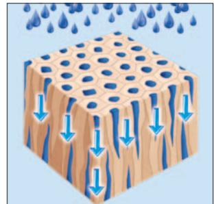
*Ohne Kapillarblocker: Unbehandeltes Holz saugt aufgrund seines Kapillarsystems Regenwasser regelrecht auf. Die Feuchtigkeit dringt in Poren und Kanäle ein. Das Holz verrottet.*
