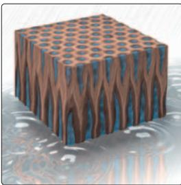
Unbehandeltes Holz saugt aufgrund seines Kapillarsystems Wasser regelrecht auf. Die Feuchtigkeit dringt in Poren und Kanäle ein. Das Holz verwittert.
