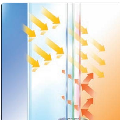
Das Glas lässt Sonnenstrahlen in hohem Maß in den Raum, Heizwärme kann dagegen nur minimal nach außen entweichen
